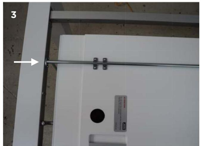
Am Joch (Foto 3) befindet sich eine weitere - vertikale und horizontale - Einstellmöglichkeit. Die Einstellung erfolgt wie oben beschrieben.
